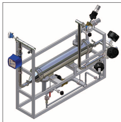
Рис. 12. Автоматическое вторичное кольцо для охлаждения воды для инъекций. ОАО Синтез, Курган.
