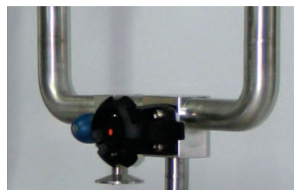
Рис. 15. Разборный клапан без застойной зоны. Московский эндокринный завод
